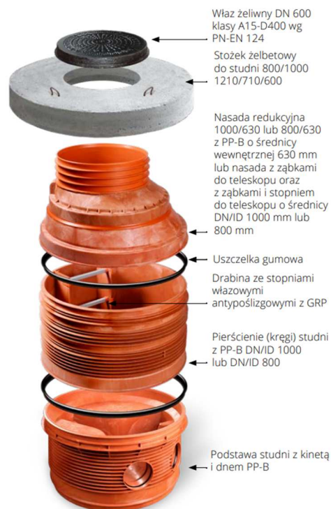
Rys. 1. Schemat budowy studzienki DN 800
